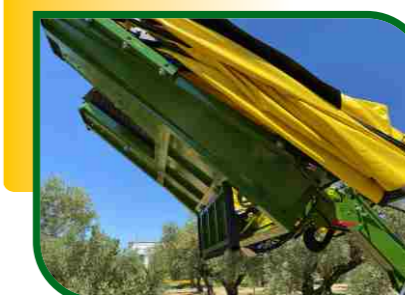
Controllo idraulico della botola di scarico Case hatch hydraulically controlled
