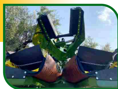
Pinza a doppia ganascia New Generation ad alte frequenze, autocentrante, autofrenante, con doppia velocità di vibrazione Double Jaw New Generation vibrating head at high frequency, self-centering, self-braking, double speed
